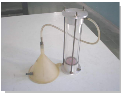
รูปที่ 11.4 แสดงเครื่องทดสอบความดันคงที่ รูปที่ 11.5 แสดงเครื่องทดสอบความดันเปลี่ยนแปลง ภาพโดย : มานิต ช่วยงาน ห้องปฏิบัติการปฐพีกลศาสตร์ วิทยาลัยเทคนิคเชียงใหม่ มี.ย. 2552
