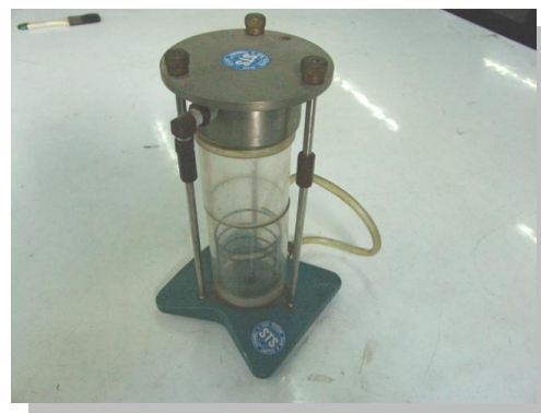
รูปที่ 11.4 แสดงเครื่องทดสอบความดันคงที่ รูปที่ 11.5 แสดงเครื่องทดสอบความดันเปลี่ยนแปลง ภาพโดย : มานิต ช่วยงาน ห้องปฏิบัติการปฐพีกลศาสตร์ วิทยาลัยเทคนิคเชียงใหม่ มี.ย. 2552
