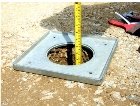
รูปที่ 9.8 แสดงความลึกประมาณ 10 เซนติเมตร รูปที่ 9.9 แสดงการคว่ำขวดทรายลงบนปากหลุม ภาพโดย : มานิต ช่วยงาน ก.ค. 2552
