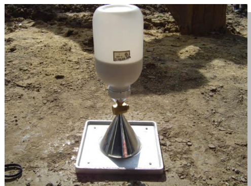
รูปที่ 9.8 แสดงความลึกประมาณ 10 เซนติเมตร รูปที่ 9.9 แสดงการคว่ำขวดทรายลงบนปากหลุม ภาพโดย : มานิต ช่วยงาน ก.ค. 2552
