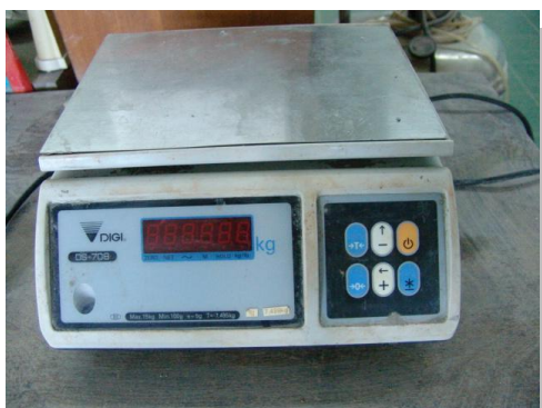
รูปที่ 9.3 แสดงเครื่องชั่งดิน 0.10 กรัมถึง 10 กิโลกรัม
